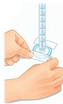
用膠帶將甲、乙兩個量筒固定在桌面，並滴入少許紅色墨水（可用食用色素調製）。
